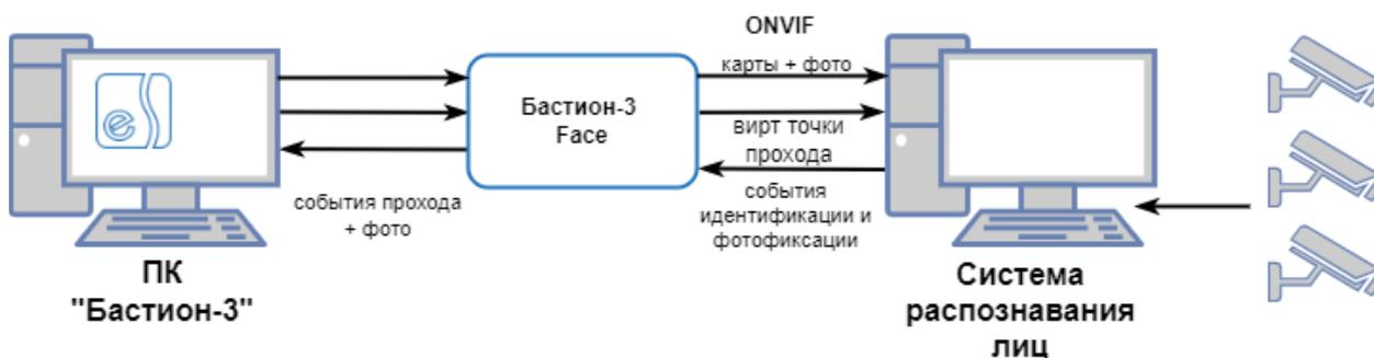
Рис. 10. Работа системы с виртуальными точками прохода
